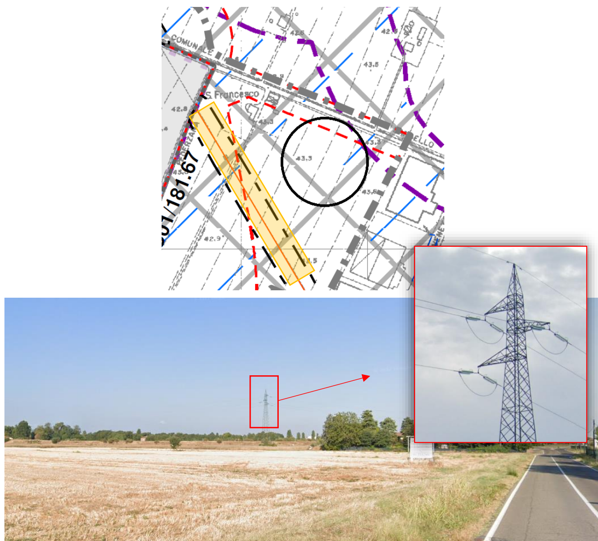
Figura 27 Individuazione DPA elettrodotto e foto su traliccio
